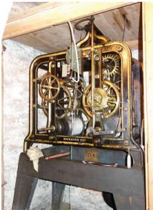
Das Uhrwerk, groß wie ein Kleiderschrank, mit vielen Zahnrädern, Hebeln und Seilzügen wurde vom Küster mit viel Sachkenntnis regelmäßig geputzt, geölt und eingestellt. Die zentnerschweren Gewichte zum Antrieb des Pendels und des Stundenschlages mussten wöchentlich mit viel Kraftaufwand mit Flaschenzügen im Turm nach oben gekurbelt werden. Nun ist die Mechanik verschlissen, Ersatzteile sind nicht mehr zu bekommen. Um einen verlässlichen weiteren
